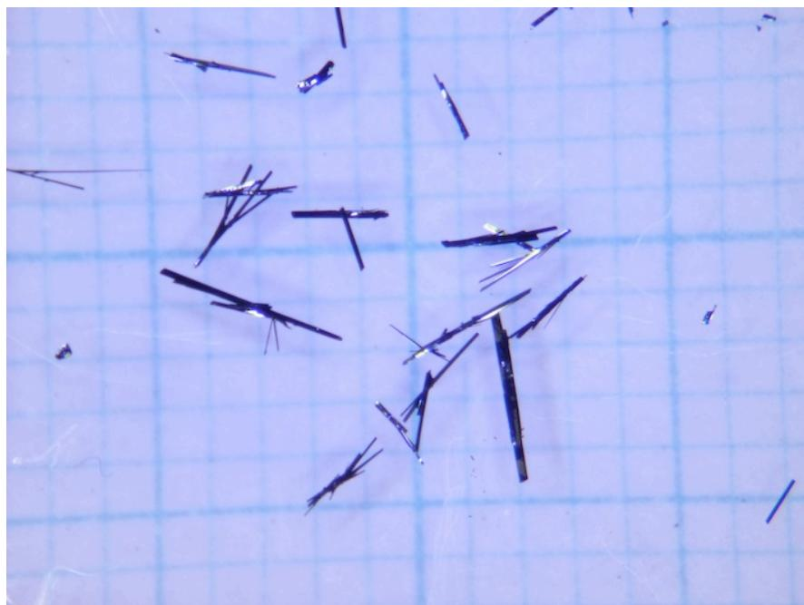
図 1：測定に使用した有機化合物  $\beta$ - $(meso\text{-}DMBEDT\text{-}TTF})_2PF_6$  の写真。数ミリ程度の長さをもった細長い形状をしている。
